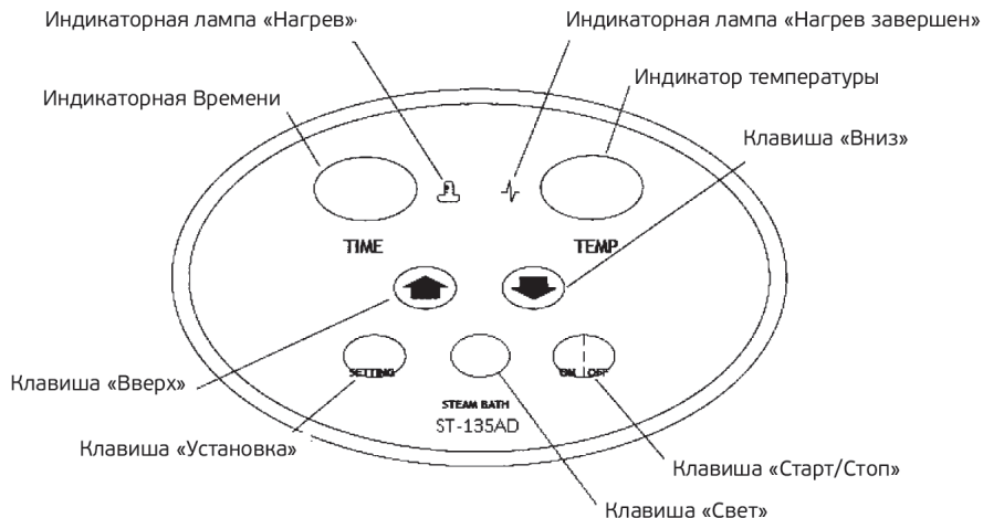
Рисунок 3. Указания по установке контроллера температуры ST-135AD
